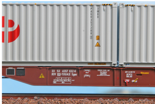
Carro intermodale Tipo Sgns Touax da 60 piedi caricato con due bulk "Paganella". Container wagon Type Sgns '60 Touax with two "Paganella" container. 60-Fuß-Intermodalwagen vom Typ Sgns Touax, beladen mit zwei 40-Fuß-Container „Paganella“.
