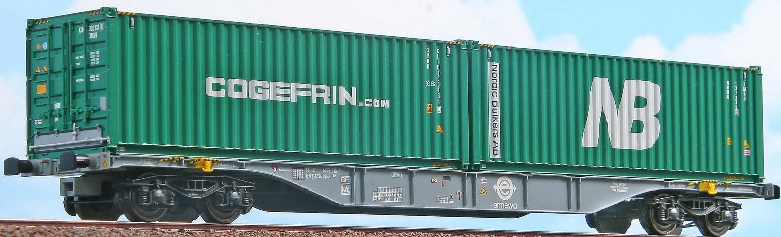
Carro intermodale Tipo Sgnss Ermewa da 60 piedicaricato con un bulk "Nordic Bulkers" e un bulk "Cogefrin".
